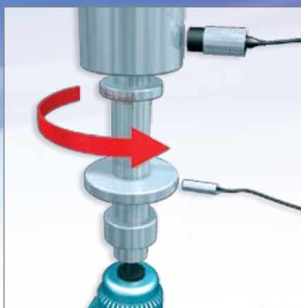
▲ Excentricitetkontroll av roterande axel
