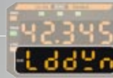
Equipado com um monitor de controlo de vida do laser que alerta para a sua deterioração.
