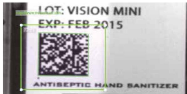
Lê um código de barras ou código 2D. A função de correspondência de seqüências de caracteres permite que esta câmara inteligente efectue uma verificação que é normalmente efectuada por um PC ou PLC.
