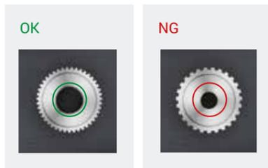
Inspeção de orientação da borracha montada
