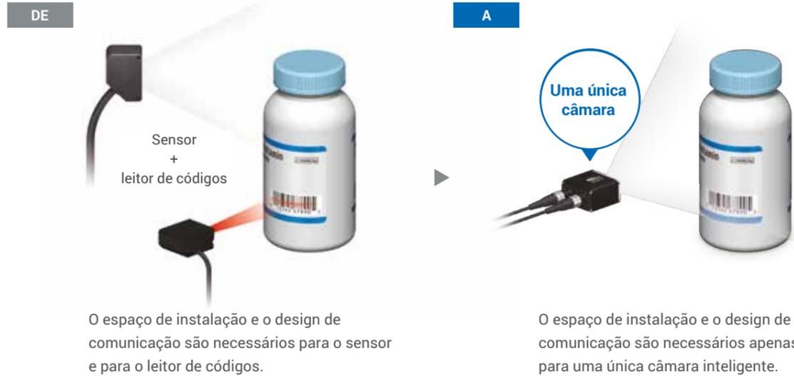
Para realizar uma tarefa de inspeção simples, como detecção de presença/ausência, detecção de cores, etc., juntamente com uma leitura de códigos ou caracteres, seria necessário um sensor altamente funcional ou um sensor combinado com um leitor de códigos para cada finalidade. A série F430-F/F420-F executa ambas as funções com sucesso, simplificando as tarefas de inspeção em geral.
