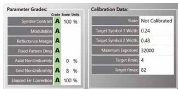
Permite uma verificação simples da qualidade de impressão dos códigos de acordo com as normas de aplicação, tais como ISO 15415, AIM DPM/ISO 29158 e ISO 15416. Também gera relatórios automaticamente.
