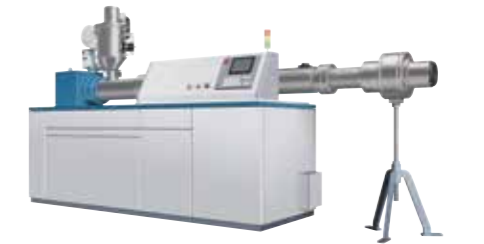
Máquina de extrusão pequena Controlo multiponto estável da temperatura, através de HMI da série NB
