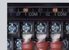
Indicadores LED nos terminais de entrada/saída para uma resolução de problemas rápida
