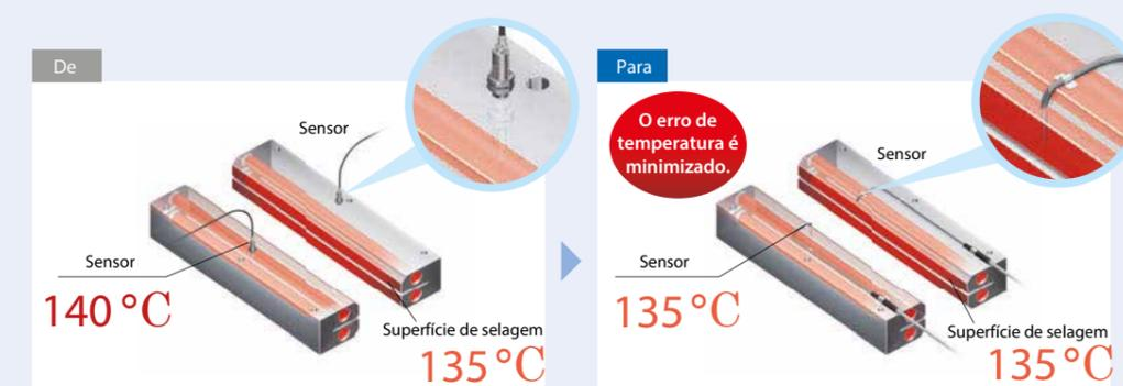
A localização imperfeita do sensor pode causar uma diferença de 5 °C relativamente à temperatura da superfície de selagem.
