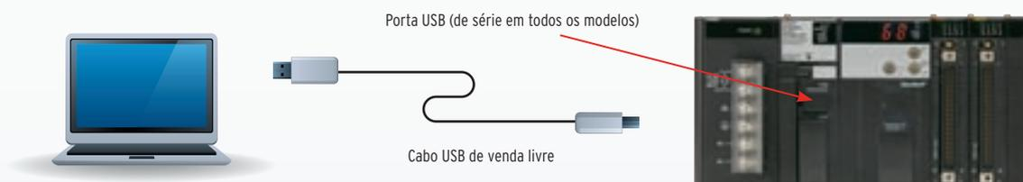
É possível aceder a um CPU CJ2 numa rede EtherNet/IP através de USB, sem necessidade de tabelas de encaminhamento ("Routing Tables")
