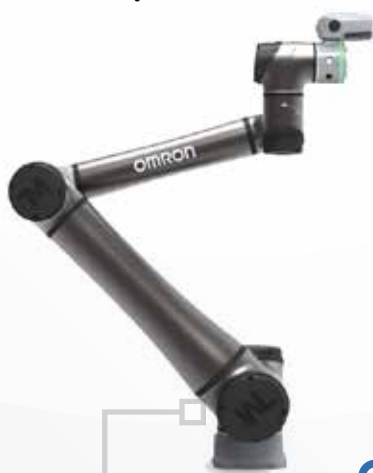
ZASIĘG MODELU OMRON TM12S WYNOSZĄCY 1200 MM
