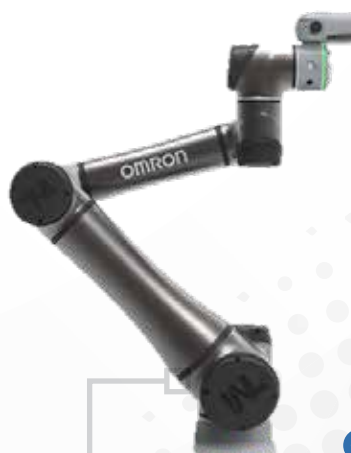
ZASIĘG MODELU OMRON TM14S WYNOSZĄCY 1100 MM
