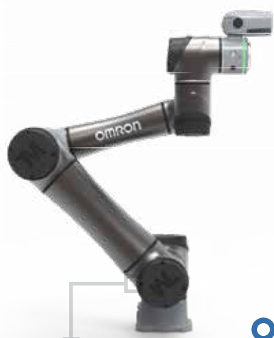
ZASIĘG MODELU OMRON TM5S WYNOSZĄCY 900 MM
