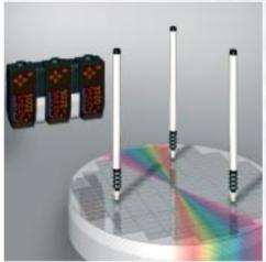
Industria dei semiconduttori: processo di allineamento preliminare dei wafer Il sensore ZX-T è ideale per verificare la planarità o l'inclinazione di un wafer prima che venga trasferito al processo successivo.
