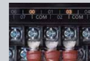
Indicatori LED dei terminali di entrata/uscita per la ricerca guasti rapida
