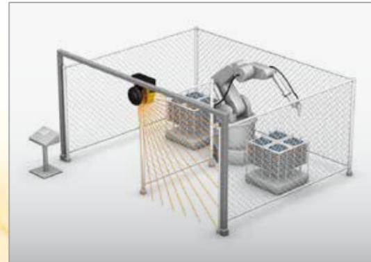
Rilevamento delle intrusioni con installazione verticale
