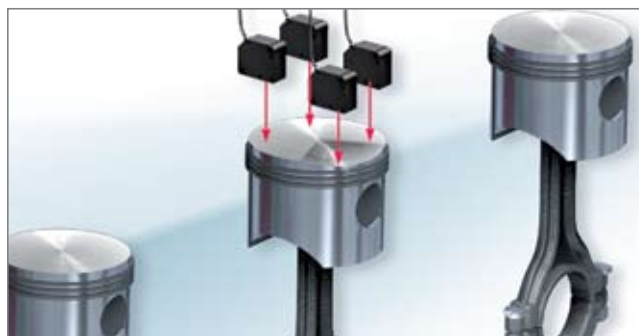
▲ Controllo della planarità del cielo dei pistoni
