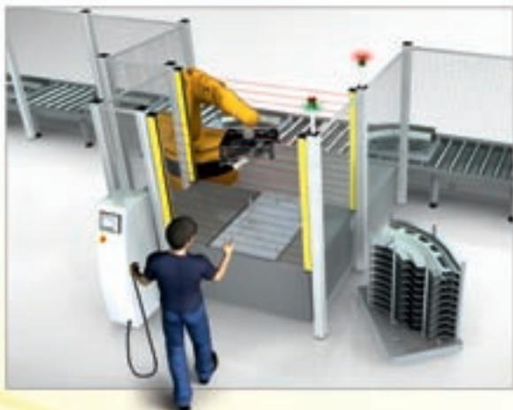
Il collegamento diretto del dispositivo manuale ad azione continua A4EG consente il funzionamento sicuro per la manutenzione o la configurazione.
