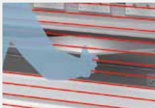
Quando viene rilevato il braccio o il corpo del lavoratore, che interrompe 3 fasci, l'uscita di sicurezza viene disattivata.
