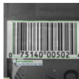
Polarizátor – kiküszöböli a becsillanásokat
