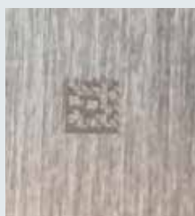
Alumínium hajszálcsíkos feldolgozás, elmosódott, alap- feldolgozás nélkül Cellaméret: 0,127 mm
