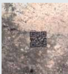
Alumíniumöntvény, alapkezelés nélkül Cellaméret: 0,127 mm
