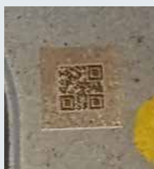
Vas fogaskerék, alapfeldolgozással Cellaméret: 0,127 mm
