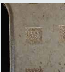
Vas fogaskerék, alapfeldolgozással Cellaméret: 0,127 mm
