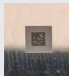
Alumínium polírozás (tükörfelület), alapozással Cellaméret: 0,127 mm
