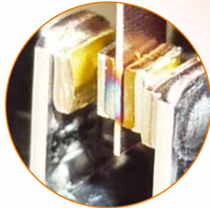
Az aranybevonatú érintkezők optimális védelmet nyújtanak.
