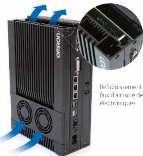
Refroidissement actif et flux d'air isolé des éléments électroniques
