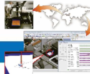
Vous pouvez non seulement afficher en temps réel le mouvement de la machine dans votre système de CAO, mais aussi le reproduire à partir des données de tracé, ce qui permet de réaliser la maintenance et le dépannage à distance.
