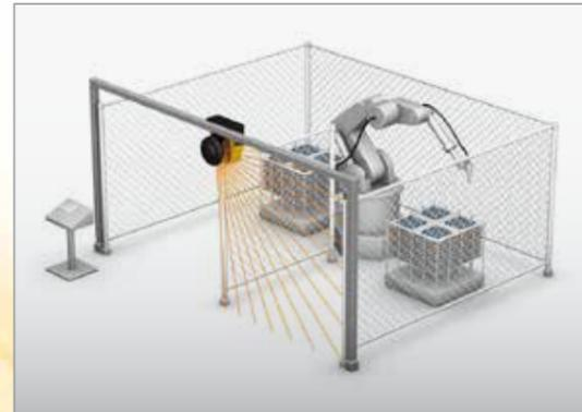
Détection d'intrusion avec installation verticale
