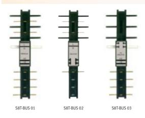
El conector en bus aislado (S8T-BUSO2) permite crear un único bloque de alimentación colectivo con voltajes de salida mezclados (24, 12 o 5 Vcc), mientras el circuito de entrada continúa a través del conector, manteniendo el cableado sencillo y fiable. Los módulos de backup utilizan el conector en bus S8T-BUSO3 para enchufarse a los bloques de alimentación.
