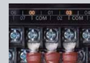
Indicadores LED de terminal de entrada/salida para una rápida solución de problemas
