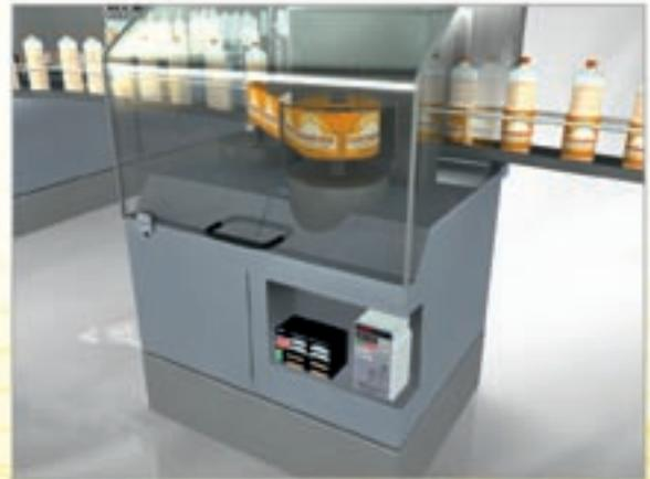
Con el modulo de seguridad de E/S se produce una parada segura, además de monitorizar el estado de los finales de carrera de puerta de seguridad.
