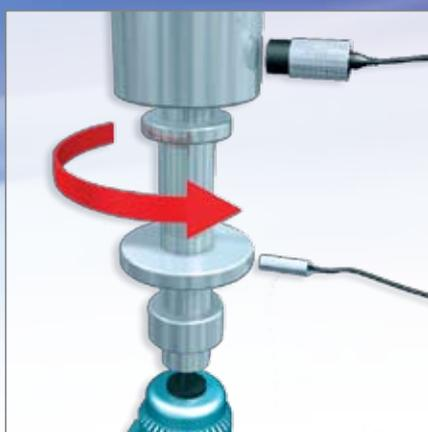
▲ Control de la excentricidad de un eje giratorio
