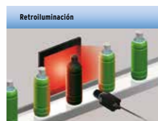
Inspecciones de la forma exterior
