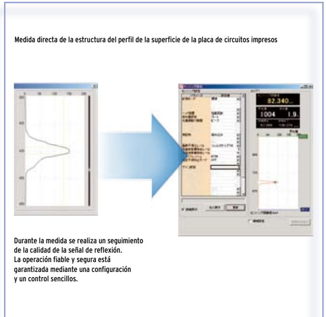
Medida directa de la estructura del perfil de la superficie de la placa de circuitos impresos
