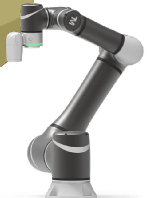
TM Roboter sind die weltweit ersten kollaborierenden Roboter mit integriertem Kamerasystem.
