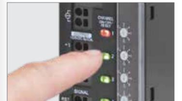
3-stufige LED-Anzeige zur einfachen Anzeige zum Status aller Abzweigkreise
