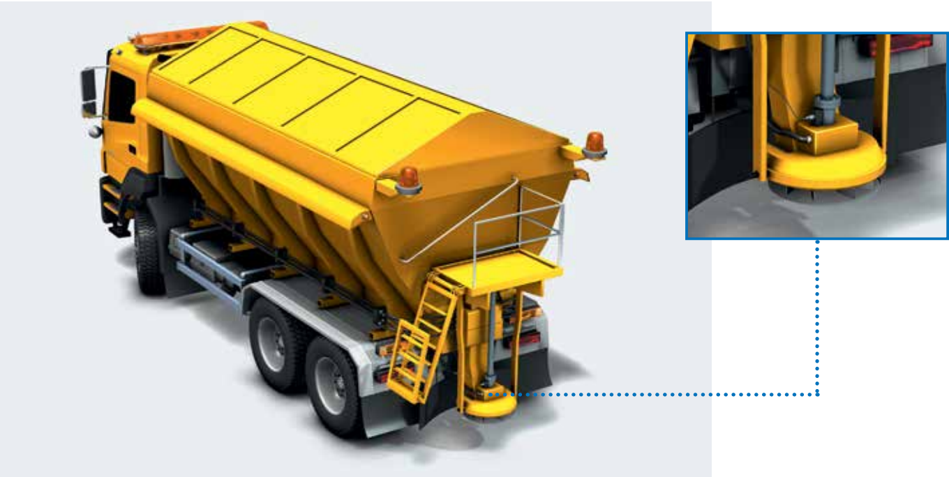
Streufahrzeug: Näherungssensoren überwachen den Streuotor, um die richtige Drehzahl und Ausbringung von Salz und Splitt auf die winterlichen Straßen zu gewährleisten. Extrem raue Einsatzbedingungen im Freien stellen höchste Ansprüche an die Zuverlässigkeit von Sensoren und Gehäuse sowie an die Vibrationsfestigkeit des Sensors.
