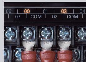
LED-Anzeigen an Eingangs-/Ausgangsklemmen für schnelle Fehlersuche
