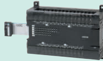
CP1W-20EDT DC-Eingänge: 12 Transistorausgänge (NPN): 8
