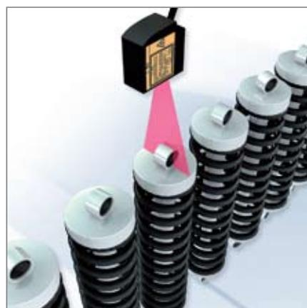
▲ Formprüfung bei Fahrzeugstrukturteilen. Der breite Strahl ermöglicht die Messung in einem einzigen Schritt
