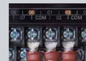
LED-indikatorer på indgangs-/udgangsterminal til hurtig fejlfinding
