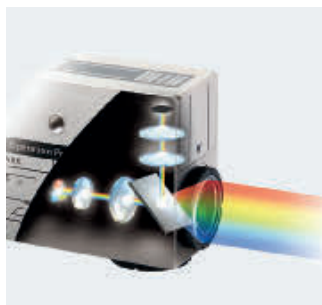
Tři zdroje světla (R, G, B) v jednom zařízení
