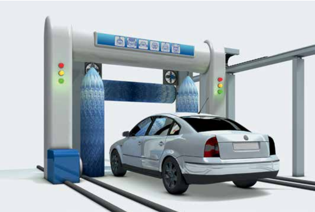
Systém mytí aut. Sensory přiblížení hlídají koncovou polohu rámu a také aktuální polohu mycích kartáčů. Sensory by měly mít dlouhou životnost, aby vydržely vysokou vlhkost a neustálé změny okolní teploty.
