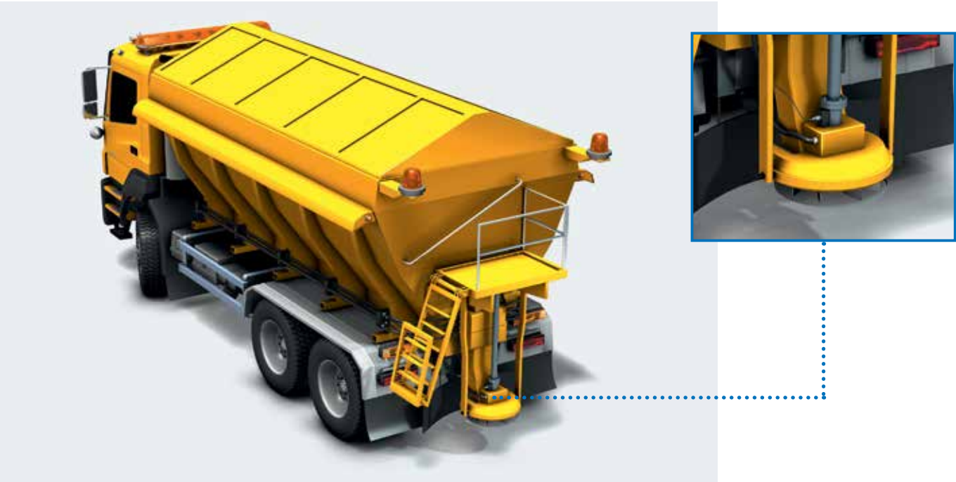
Silniční rozmetadlo. Sensory přiblížení kontrolují rotor, aby byla zajištěna správná rychlost posypu pískem a činidly na silnicích v zimě. Extrémně náročné podmínky venkovních aplikací vyžadují nejvyšší spolehlivost senzorů, odolnost pouzdra a odolnost senzoru proti vibracím.
