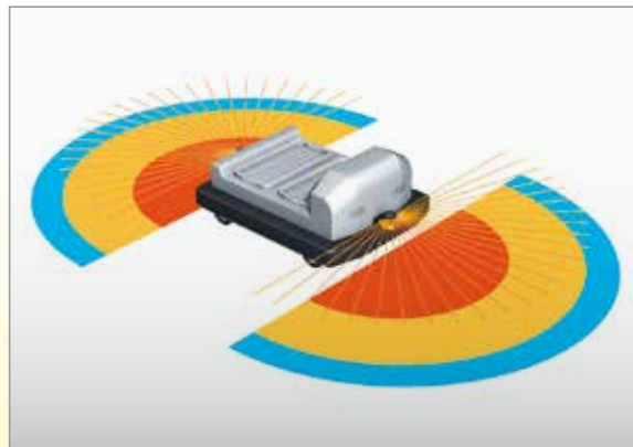
Sledování prostoru před a za vozidlem
