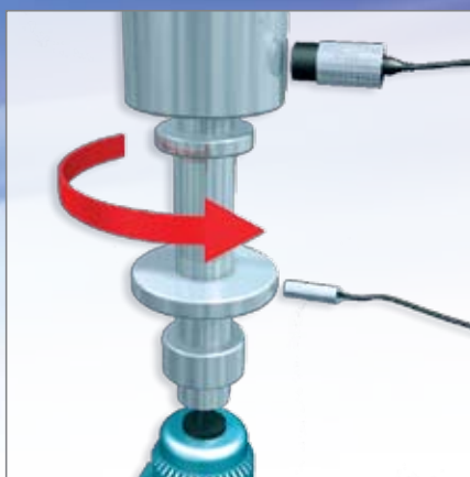
▲ Měření výstřednosti rotujícího hřídele
